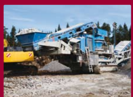
TRÉMIE Hardox 500/550/600 est le choix qui s'impose dans la trémie qui conduit vers le concasseur.
