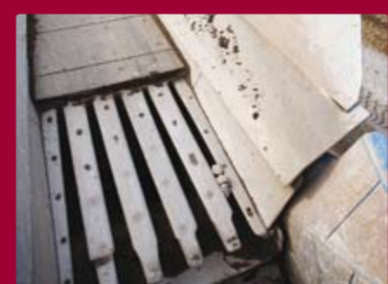
GODET Hardox 450/500/550 dans le godet entier ou sur lame d'attaque et sur les côtés suivant le type d'usure.
