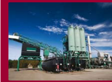
ÉQUIPEMENT DE PRÉPARATION DE L'ASPHALTE Hardox 450/500/550 dans les tôles de blindage et dans les chutes de gravier. Hardox 450/500 dans les spirales du tambour. Hardox 450/500 sur parois du conteneur entre le tambour et le déversoir.
