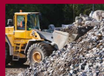
GODET D'EXCAVATRICE Hardox 450/500/550 dans le godet d'excavatrice. Hardox peut être utilisé dans le godet entier ou seulement sur lame d'attaque et sur les côtés, en fonction du type d'usure.
