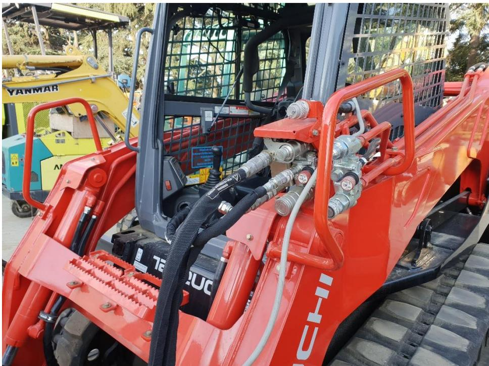
Débit minimum de 40l/min avec un maxi de 90l/min
