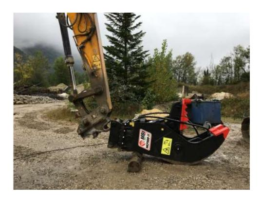
Mission: Concassage et séparation du matériau démoli Le broyeur fixe à dents interchangeables MCP-IT de Mantovanibenne est l'outils idéal pour le concassage et la séparation du matériau démoli. Ses autres principales caractéristiques:
