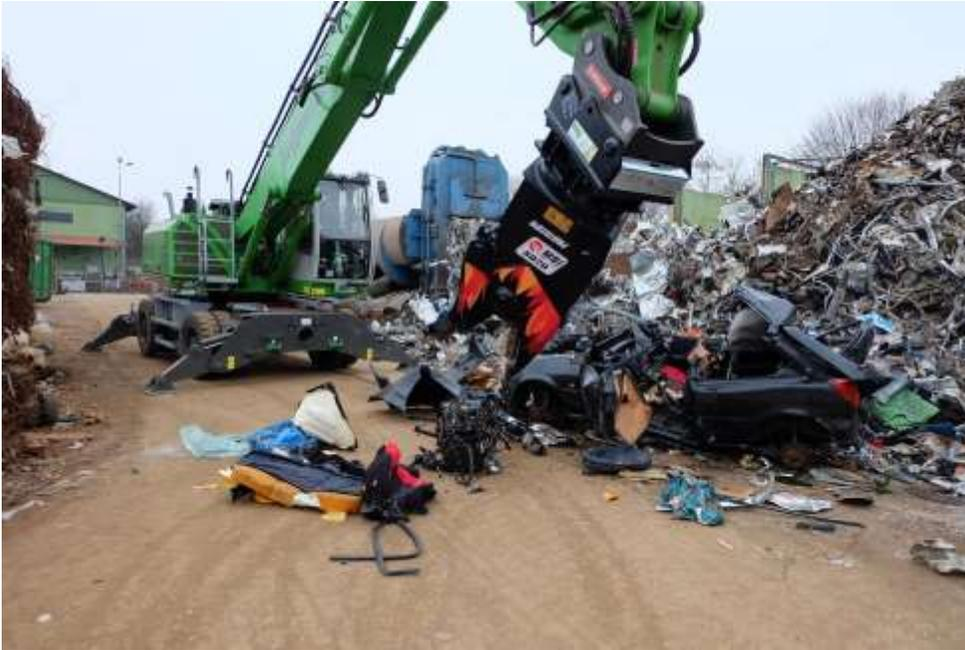
**La cisaille de démantèlement SD est particulièrement adaptée à la démolition et au démantèlement des véhicules hors d'usage.**
